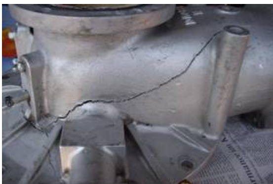
Vom Frost zerstörtes Pumpengehäuse
