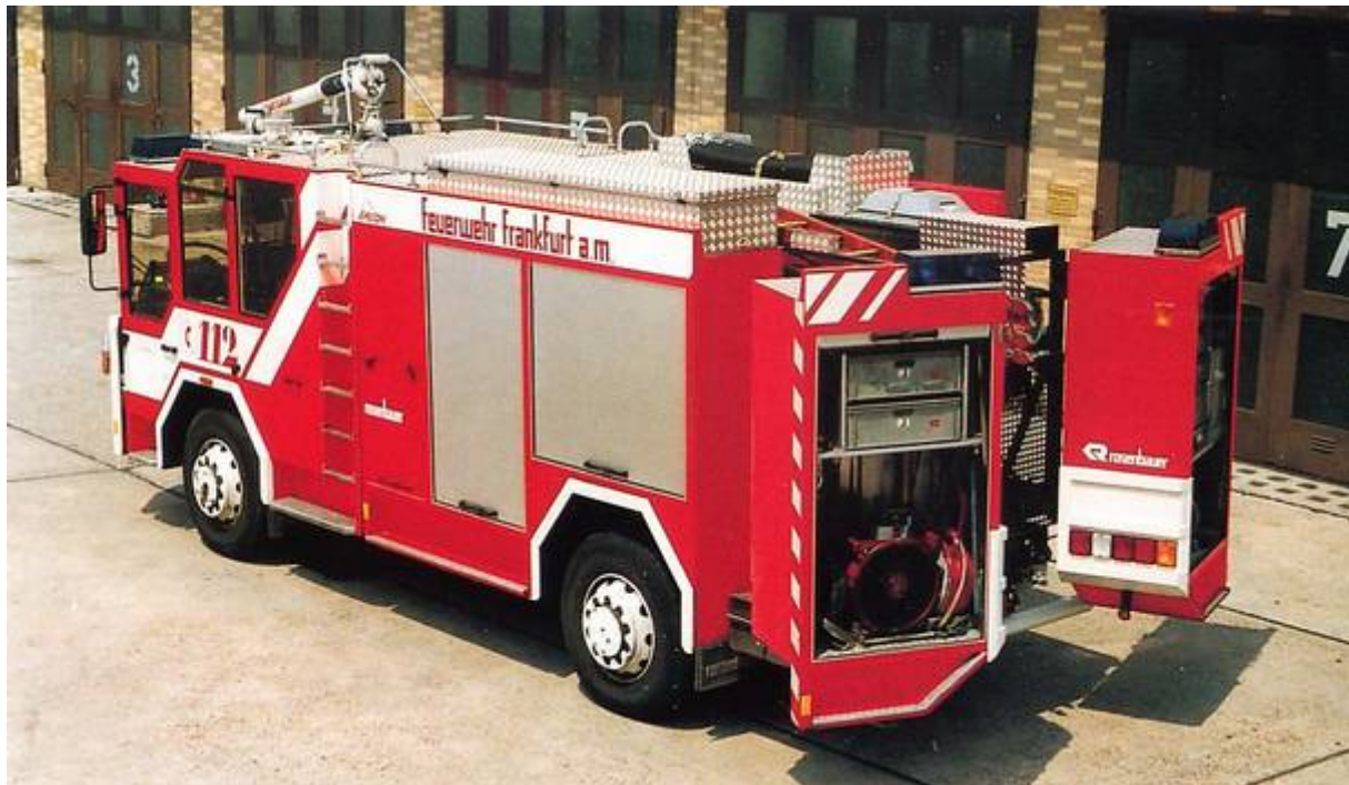
Der Frankfurter Falcon, hier bereits nach längerer Dienstzeit und diversen Umbauten. Gut erkennbar sind auf dem Foto die abklappbaren hinteren Geräteräume, die Wartung und Arbeiten am Heckmotor erleichtern.
