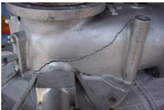
Vom Frost zerstörtes Pumpengehäuse
